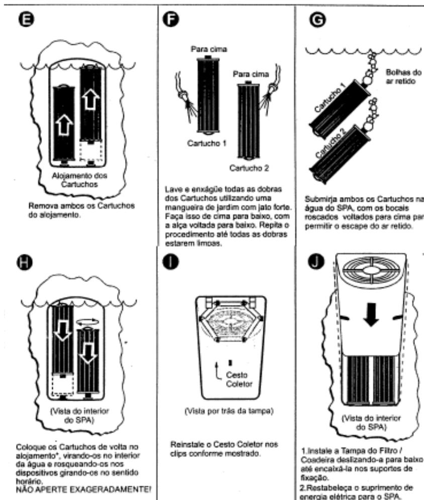
Impurezas maiores são filtradas pelo Cesto Coletor e pelo Cartucho do Filtro interligado à Bomba, tanto durante os ciclos de aquecimento e filtração como nos períodos de utilização da hidromassagem. O Cesto Coletor e os Cartuchos do Filtro removem as matérias flutuantes e em suspensão, garantindo uma insuperável qualidade da água. Para garantir um ótimo desempenho do SPA, limpe o Cesto Coletor e ambos os Cartuchos do Filtro mensalmente ou conforme for necessário.
