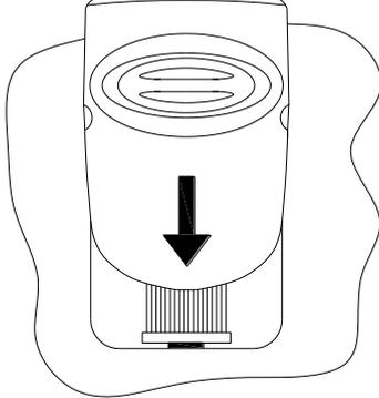
**2 - Levante a tampa do filtro, segurando-a pelos rebaxos laterais, para desencaixá-la dos suportes e removê-la.**
