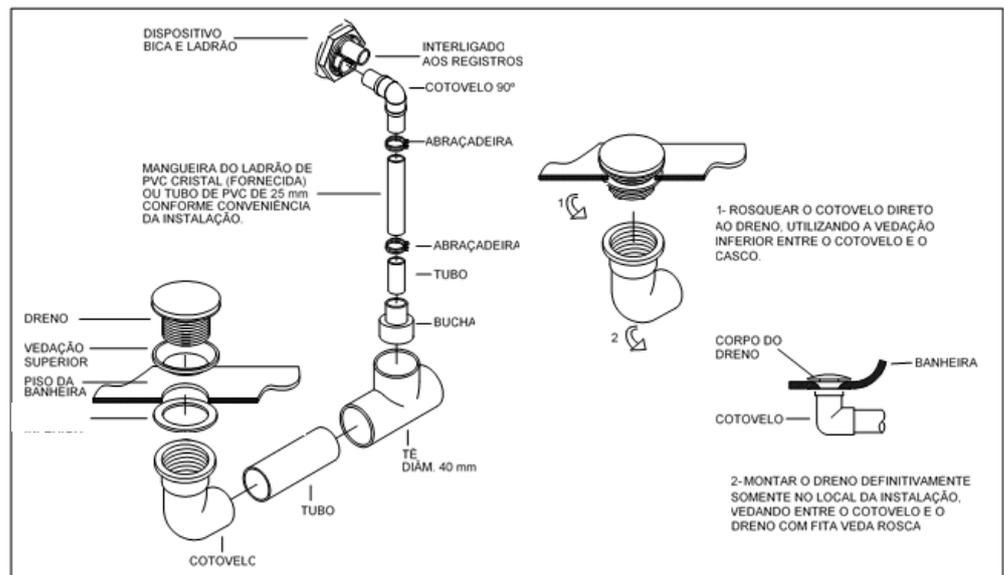
Após efetuar as vedações necessárias e retire o excesso de silicone com uma flanela seca. Nunca use solventes.
