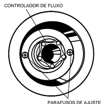
Hidroterapia para dar a direção desejada ao jato d'água. O esforço necessário para o posicionamento depende do aperto dos dois parafusos existentes no dispositivo, sendo menor quando o jato está desligado.
