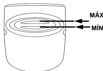
O nível de água no SPA deve ser mantido dentro dos limites conforme indicado acima. A água derramada durante o uso ou perdida por evaporação deve ser reposta para manter o nível.
