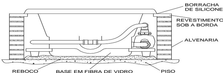
Nesses casos, uma boa vedação ao redor da borda deve ser feita aplicando-se borracha de silicone em quantidade adequada para vedar a fresta existente entre revestimento sob a borda e face interna da borda do SPA, conforme indicado na figura ao lado:
