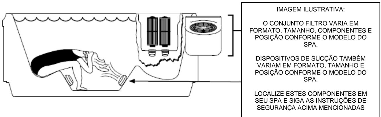
**Nunca use o SPA sem as proteções dos dispositivos de sucção, filtros, tampa do filtro ou com componentes defeituosos, soltos, quebrados ou faltando.**
